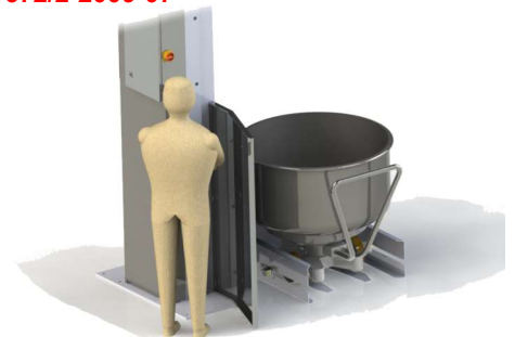
Totmannsteuerung mit Zutrittschutz (Wand)
